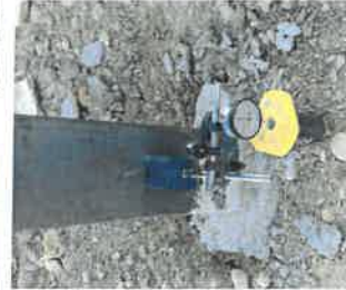
Photo 5 : Exemple d'ancrage au sol par pieux battus (Source : URBASOLAR)
